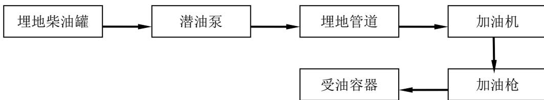
图 2.5-4 柴油加油工艺流程图示意简图
